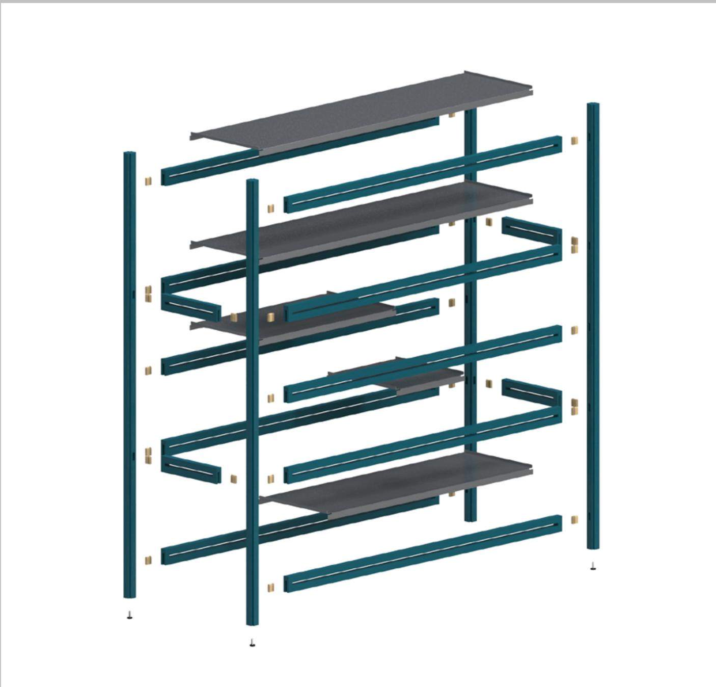
Sistema di assemblaggio *tool-free*.
